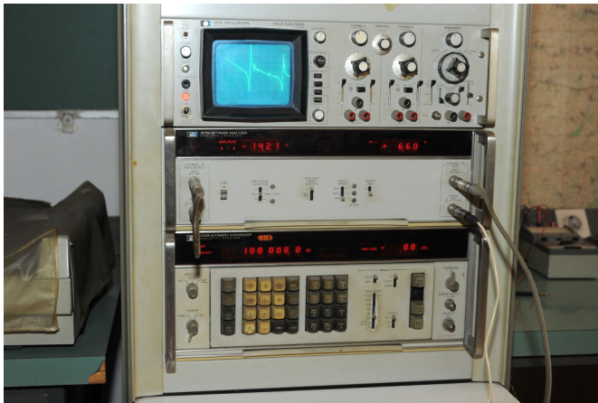
Sl.1. Izgled automatskog analizatora mreža HP3042A.
