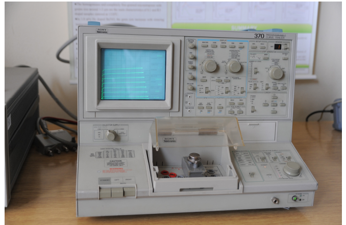
Sl.2. Izgled programabilnog trasera SONY Tektronix 370
